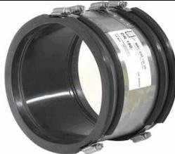
*Giunto di collegamento elastico in gomma MSC con fascette di tenuta e rinforzo centrale in acciaio inox AISI 304 ; è la soluzione tecnicamente corretta per montare condotte in un sistema elastico per garantire la perfetta tenuta idraulica e al contempo assorbire e compensare disassamenti, cedimenti e vibrazioni di condotte aeree; pressione max 2,5 bar*
