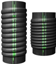
*Il manicotto elastico in gomma S-Flex è utilizzato per compensare disassamenti, cedimenti, vibrazioni di condotte non interrate, in particolare su strutture di drenaggio nei ponti. La struttura in gomma è rinforzata con anelli in acciaio per compensare o assorbire eventuali movimenti ; applicazione diretta sul diametro esterno del tubo con fascette in acciaio. Diametri standard dal 100 al 500mm.*
