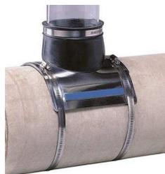
*L'innesto laterale in gomma T-flex è l'elemento di giunzione tra la caditoia e la condotta di smaltimento delle acque provenienti dalle superfici asfaltate. Il suo compito principale è quello di garantire la perfetta tenuta idraulica e al contempo assorbire e compensare disassamenti, cedimenti e vibrazioni di condotte aeree; applicazione su tutti i tipi di tubo liscio e su tutti i diametri.*
