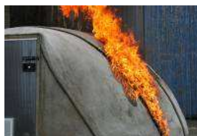
il rifugio costruito in CC ha un'ottima resistenza al fuoco
