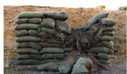
esito della stessa aggressione, subita dalla barriera non rinforzata con CC
