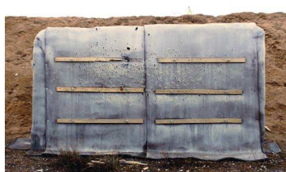
dimostrazione di aggressione subita dalla barriera rinforzata con CC
