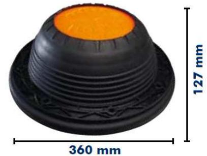
**VOCE DI CAPITOLATO :** fornitura di valvola di sicurezza di fondo per prevenire danni dovuti all'innalzamento della falda o alla presenza di gas e avente : corpo e flangia in PP Omopolimero con protezione anti UV , membrana in EPDM , flangiatura PN10, portata 5000 l/h , attivazione con 60cm H2O , contropressione max 10m H2O
