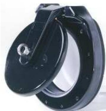
**VOCE DI CAPITOLATO** : Fornitura di valvola antiriflusso fine linea a battente verticale costruita in poliestere rinforzato e gel-cot isoftalico , metallerie in acciaio inox AISI 316 , per accoppiamento a parete verticale o a flangia ; tenuta idraulica 0,8 bar; guarnizione di tenuta in EPDM
