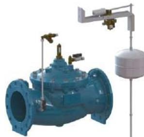
Valvola di sezionamento a galleggiante completa di sfioro / sostegno di una minima pressione di monte
