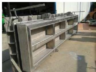
Clapet in acciaio per sezioni rettangolari
