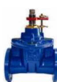
Valvola a saracinesca in ghisa sferoidale a cuneo gommato corpo piatto con indicatore di posizione UNI 10779
