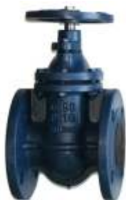
Valvola a saracinesca in ghisa grigia a tenuta metallica e corpo piatto di tipo asta non saliente
