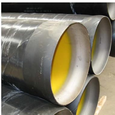
Tubi in acciaio al carbonio per condotte di acqua e gas
