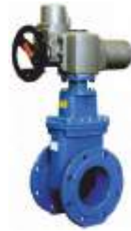
Valvola a saracinesca in ghisa sferoidale a cuneo gommato con attuatore elettrico
