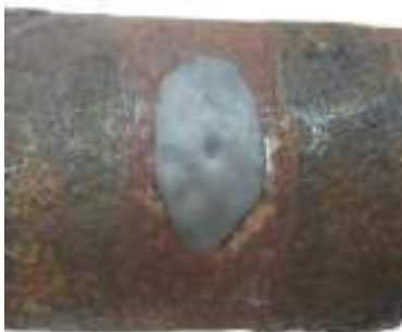
Bi-componente epossidico sigillante putty
