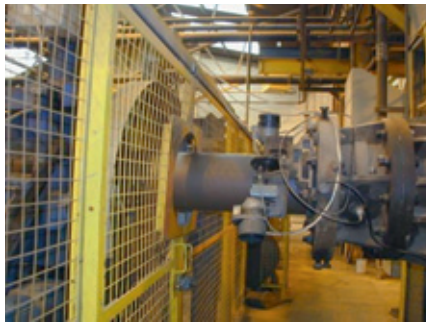
Fase di estrusione del tubo
