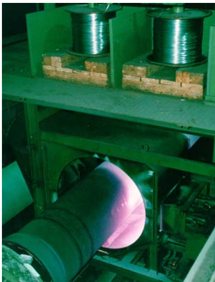
Zincatura (ZnAl o Zn) del tubo e del bicchiere
