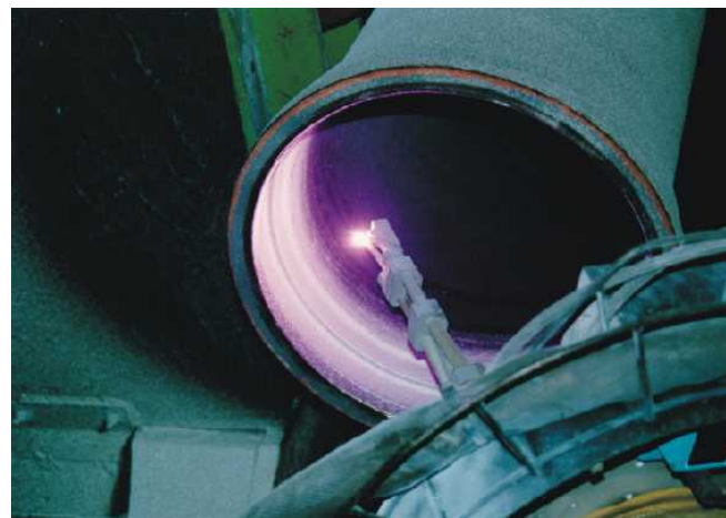
Zincatura (ZnAl o Zn) del tubo e del bicchiere
