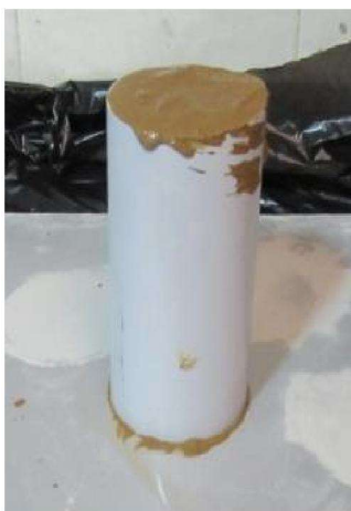
Figura 4.7 CLSM Prova di resistenza alla compressione non confinata del CLSM in base alla norma ASTM D4832
