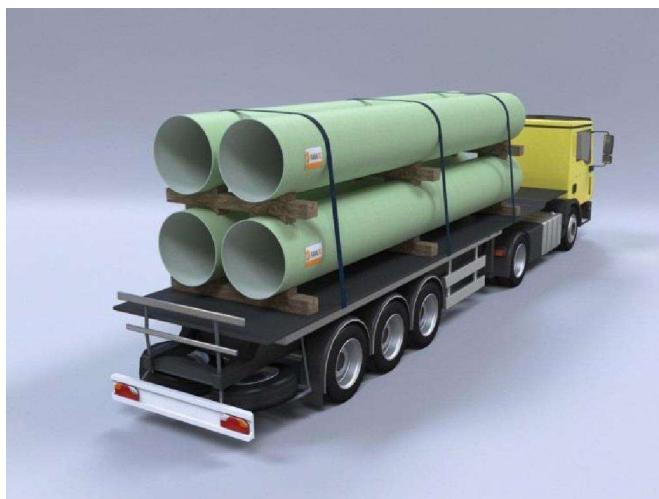
Figura 21 Carico ammissibile per il trasporto dei tubi
