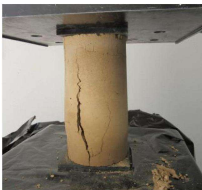
Figura 4.7 CLSM Prova di resistenza alla compressione non confinata del CLSM in base alla norma ASTM D4832
